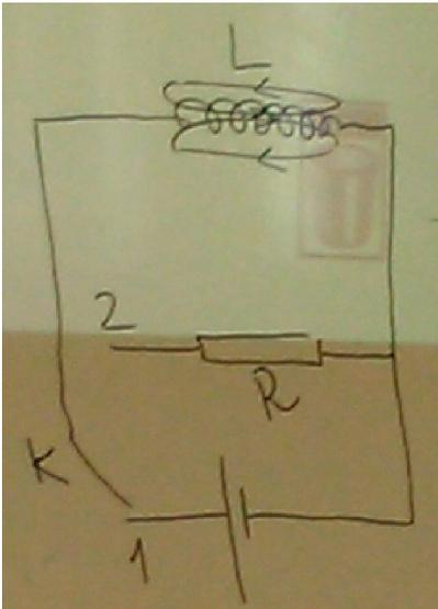
Ключ в положении 1 и по катушке течёт ток  $I$  и создаётся магнитное поле, сопротивление  $R$  - холодное, ключ резко в положении 2, ток в цепи протекает через  $R$  и постепенно убывает. В итоге, магнитное поле исчезает, а  $R$  нагревается. Вывод: магнитное поле является носителем энергии.
